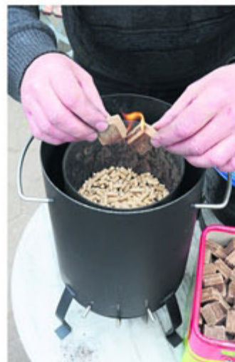
Eine Handvoll „Wundererde“ (oben). Wesentlicher Bestandteil von Terra Preta ist Holzkohle. Rainer Sagawe stellt sie aus Pellets in seinem Pyrolyseofen her (unten) und nutzt die Wärme zum Kochen. Auch der Bio-Haushaltsmüll (unten rechts) wird Bestandteil der schwarzen Erde.
