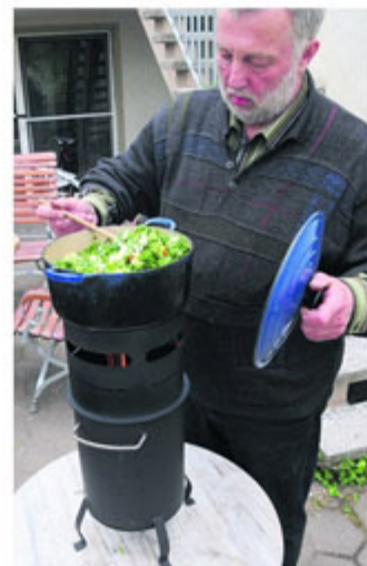
Eine Handvoll „Wundererde“ (oben). Wesentlicher Bestandteil von Terra Preta ist Holzkohle. Rainer Sagawe stellt sie aus Pellets in seinem Pyrolyseofen her (unten) und nutzt die Wärme zum Kochen. Auch der Bio-Haushaltsmüll (unten rechts) wird Bestandteil der schwarzen Erde.
